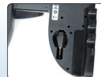
... oder die Einstellbarkeit der Federvorspannung an den Knüppel-Aggregaten
