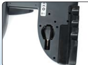
... oder die Einstellbarkeit der Federvorspannung an den Knüppel-Aggregaten
